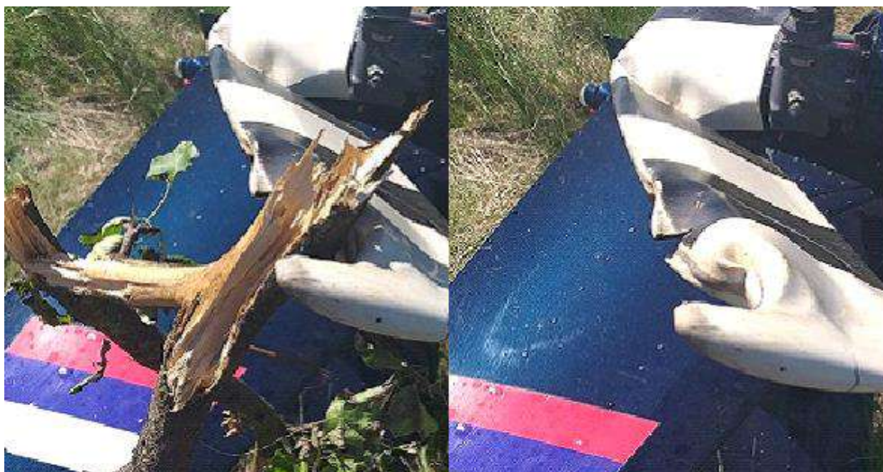
Рис. 8. Повреждения лопасти РВ от столкновения с веткой
